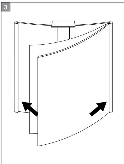
Nach Einlage des Papiers die Abdeckung auf einer Seite einsetzen und das Türschild schließen, indem die Abdeckhaube auf der anderen Seite in das Profil hineingedrückt wird.
