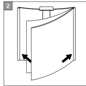
Nun kann die beschriftete Papiereinlage positioniert werden. Nach Einlage des Papiers die Abdeckung auf einer Seite einsetzen und das Türschild schließen, indem die Abdeckhaube auf der anderen Seite in das Profil hineingedrückt wird.
