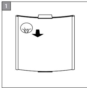
Die PVC-Haube entnehmen Sie, indem Sie den beiliegenden Sauger auf die Scheibe pressen und anschließend die Haube nach unten rausziehen.
