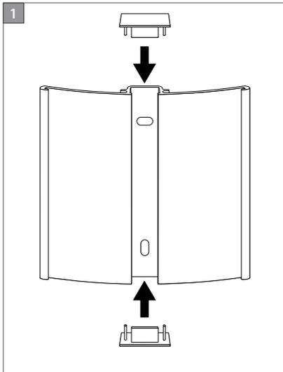
Falls die Abdeckkappen noch nicht am Schild angebracht sind, diese oben und unten in das Profil einführen. Achten Sie darauf, dass die Führungsstifte nicht verkanten. Für die Wandmontage und das Einlegen/Entnehmen der Beschriftung müssen die Kappen nicht abgenommen werden.
