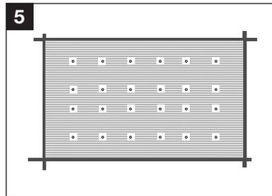
**5** Zu verklebende Elemente abnehmen. Anschließend die Flächen von Staub und Schmutz reinigen. Kleber (bitte Gebrauchsanweisung beachten) mittels Zahnpachtel auf den Straßenbelag auftragen.
