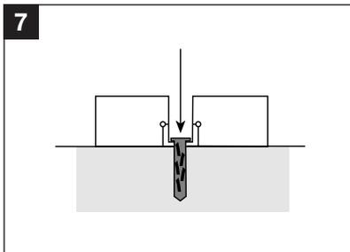
**7** Dübel bis auf die Armierung des Elementes einstecken (Dübelkragen oberhalb der Armierung).
