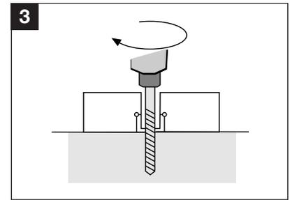
**3** Alle Montagelöcher  $\varnothing 12$  mm in Untergrund mind. 110 mm tief bohren.
