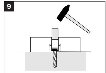
**9** Verschlussstopfen mit Wasser benetzen und mit Hammer bündig einschlagen.
