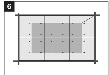
**6** Elemente auf die vorbereitete Fläche legen und ausrichten. Der Zeitraum zwischen Klebeauftrag und dem Auflegen der Elemente darf nicht länger als max. 30 Min. betragen.
