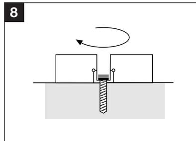
**8** Schraube mit U-Scheibe sofort eindrehen, bis der Schraubenkopf auf der Armierung fest aufsitzt.
