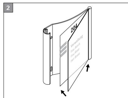
Die beschriftete Papiereinlage positionieren und mit der Abdeckhaube unter die Nut schieben.
