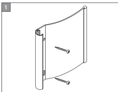
Das Clipprofil aufklappen und die PVC-Haube entfernen.
