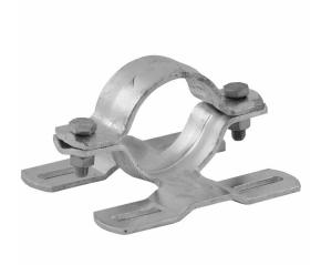
Material: Stahl (feuerverzinkt)Durchmesser: 60,3 mmLochabstand: 70 mm
