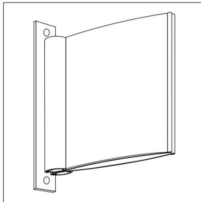
Dieses Schild kann beidseitig eingesetzt werden. Die Farbgebung erfolgt anhand der Abschlussleisten auf beiden Seiten. Die Beschriftung erfolgt hier unmittelbar auf die Beschriftungsfläche durch selbstklebende Folienbuchstaben oder durch Brandschutz- sowie Fluchtwegsymbole.
